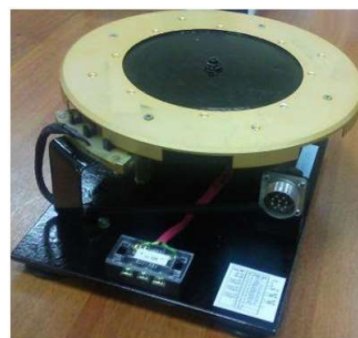
Hình 3. Bàn thực nghiệm RPS của máy điện từ kháng
