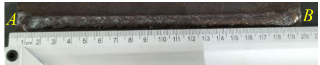
a. Đường hàn dài 200 mm (Từ điểm A đến điểm B)
