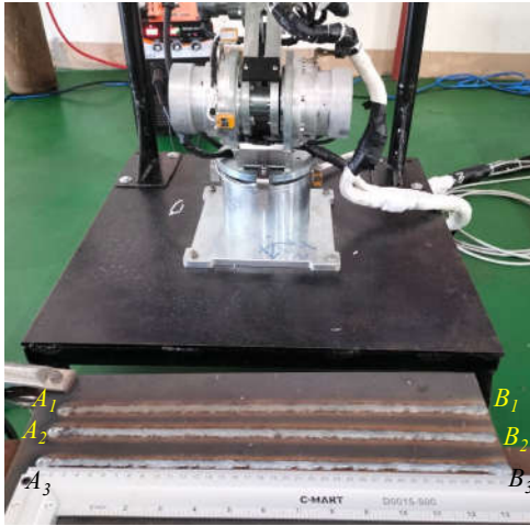
d. Ba đường hàn có cùng chiều dài 380 mm (Từ điểm A_1 đến điểm B_1 ; Từ điểm A_2 đến điểm B_2 ; Từ điểm A_3 đến điểm B_3 )
