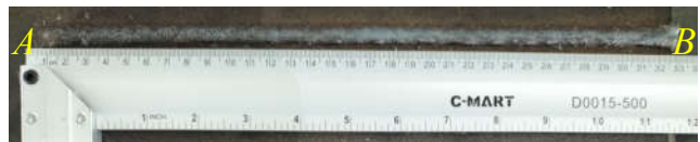
b. Đường hàn dài 330 mm (Từ điểm A đến điểm B)
